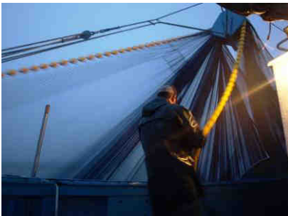
La toile et la ralingue flottante sont virées et rangées au fur et à mesure (Photo : S. Lecerf)
